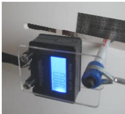
Détail du capteur d'effort et de la « mesure de distance » avec repère et réglage.
